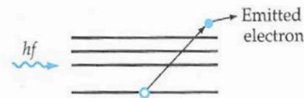
**Photoeffekt** (ganze Photonenenergie löst Elektron vom Atom)
